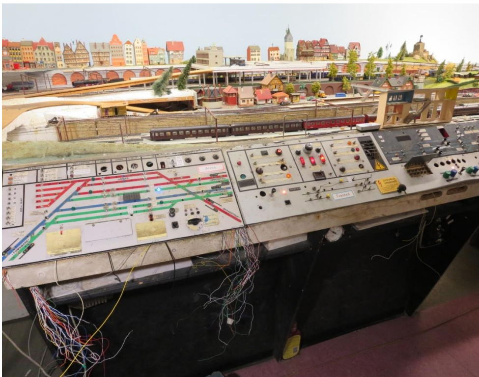
En del af kontrolbordet med sportavlerne. De mange løse ledninger????
